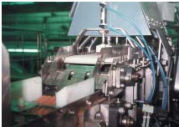
Figura 5.- Los paquetes que muestran a la cámara su lado impreso deben ser volteados cuando descenden hacia el sistema de control de calidad.
