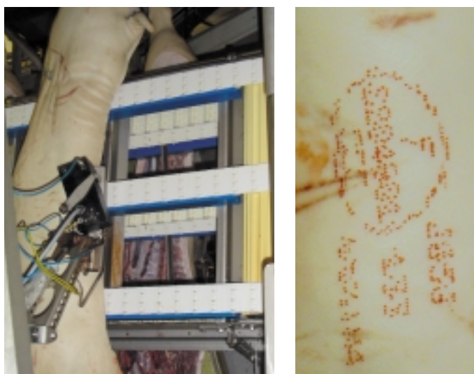
Figura 22. Sistema de marcatge de les canals indicant el percentatge de magre.
