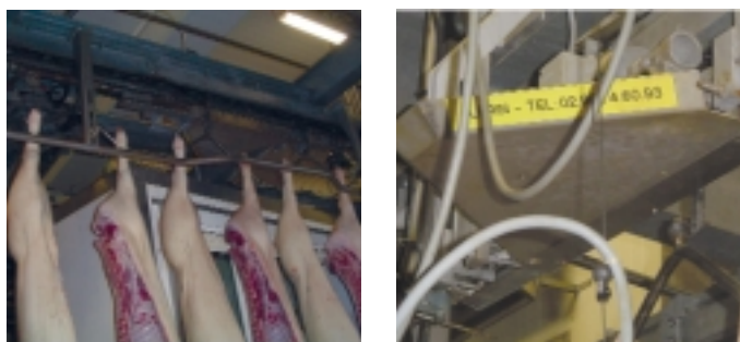
Figura 20. Detall de les bàscules dinàmiques que permeten realitzar la pesada en continu.
