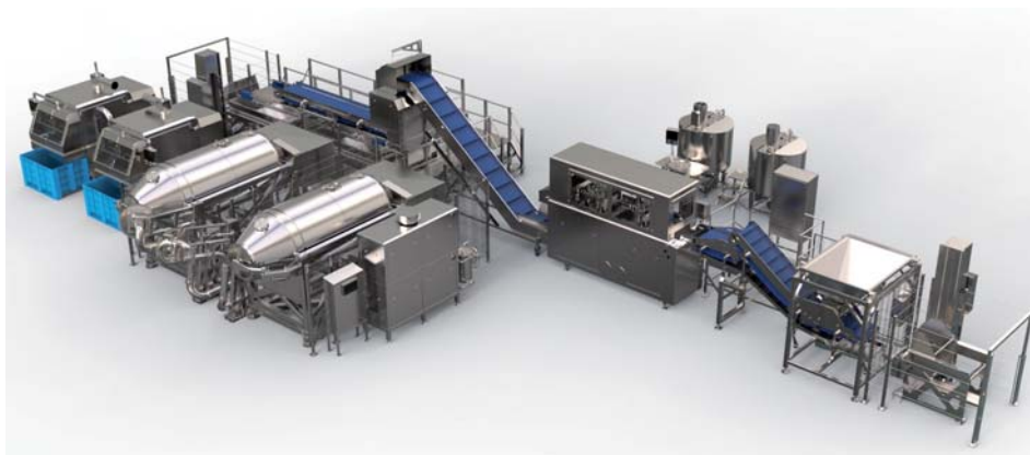
Imagen 4. Línea con diferentes fases conectadas por cintas. Transporte automático.
