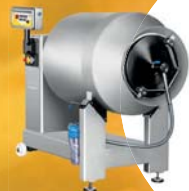
SAP 400 Bombo al vacío para masaje y salazón.
